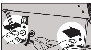
3. Нажмите кнопку подачи газа и, держа её в нажатом состоянии, многократно нажмайтесь на кнопку пьезоэлектрического воспламенителя.
