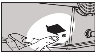
5. След пускането на бутона за подаване на газ пламъкът продължава да гори.
